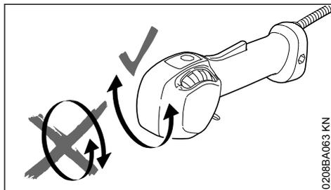
Entre le déballage de la machine et le montage de la poignée de commande sur le guidon, il ne faut **pas** faire pivoter la poignée de commande autour de son axe longitudinal.
