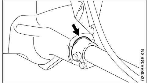
Un élément en caoutchouc amortissant les vibrations est intercalé entre l'ensemble moteur et le tube. Bei erkennbarem Verschleiß oder spürbar ständig erhöhten Vibrationen prüfen lassen.
