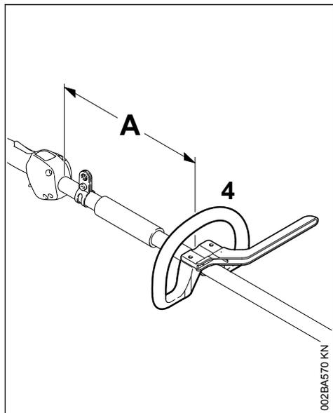
En modifiant la distance (A), on peut amener la poignée circulaire dans la position la plus confortable suivant l'utilisateur et l'utilisation prévue.
